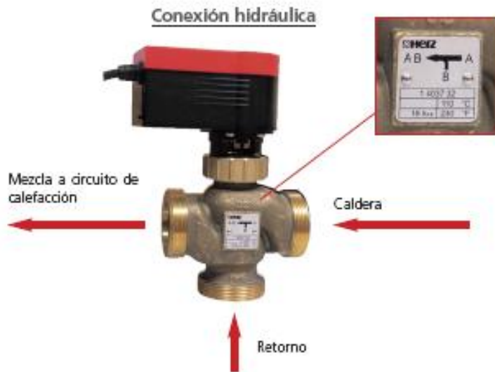
Imagen 14. Válvula mezcladora 3 vías con servomotor
