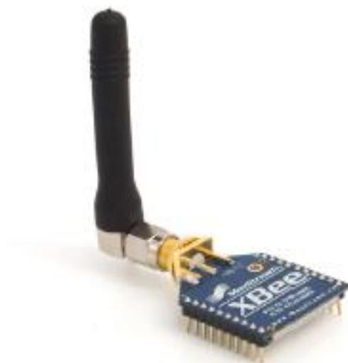
Figura A.6: Módulo XBee 802.15.4
