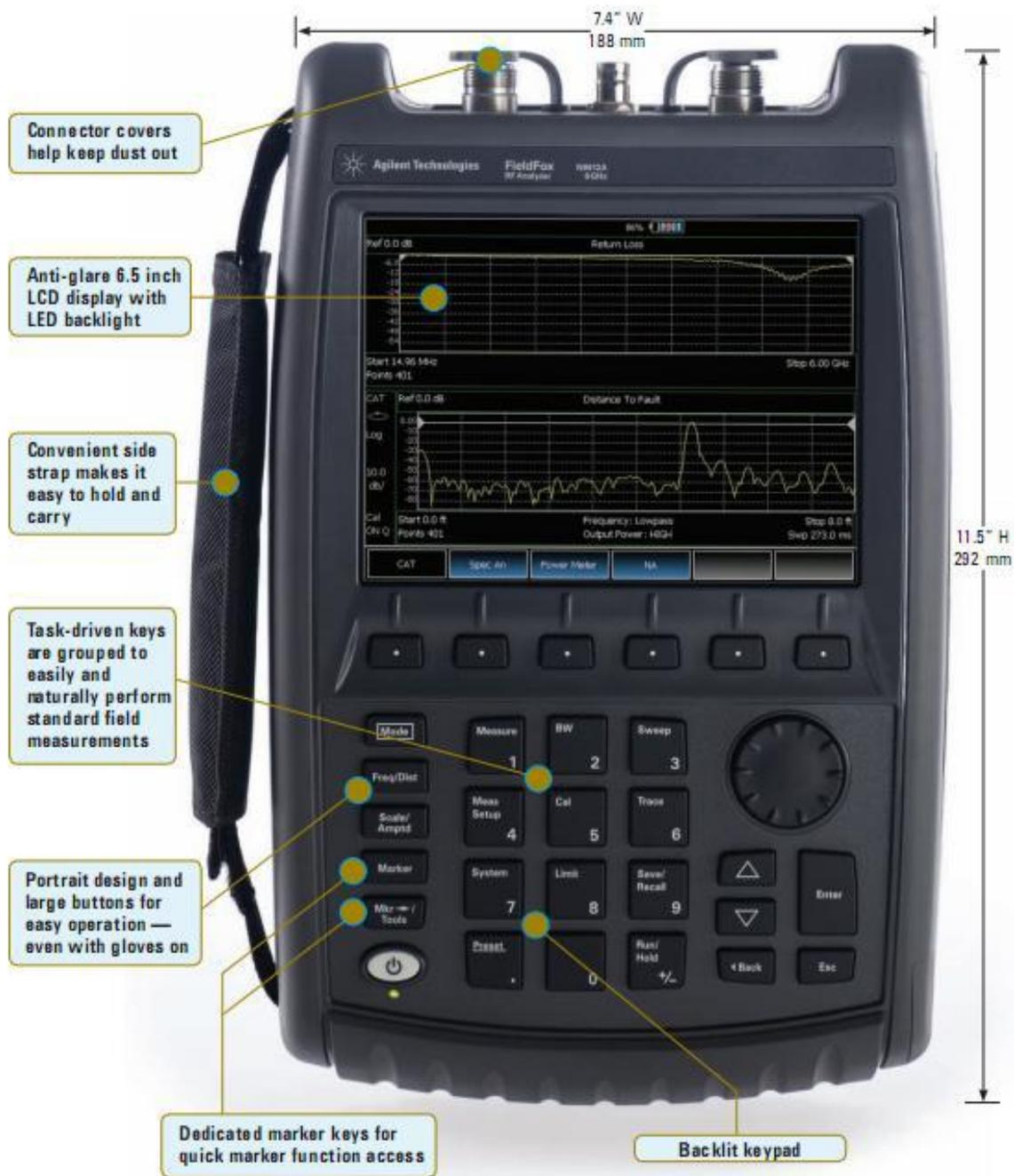
Figura B.1: Vista frontal del analizador RF field fox N9912A
