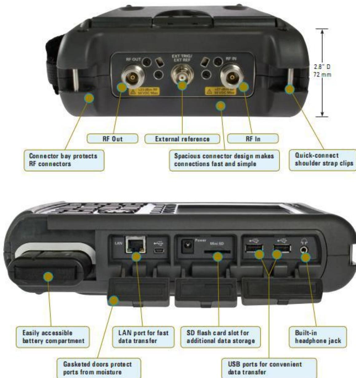
Figura B.2: Vista superior e inferior del analizador RF field fox N9912A
