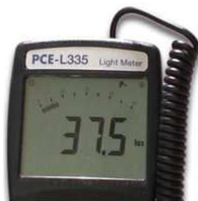
Visión del display del luxómetro PCE-L335 realizando una medición en luxes.
