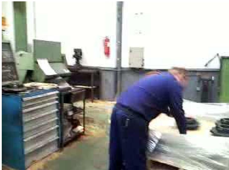
2- Una vez que la pieza está mecanizada el trabajador la retira de la máquina y la coloca momentáneamente en un mueble en el que hay una pistola de aire comprimido que utiliza para retirar las virutas que han quedado en la pieza tras su mecanización.
