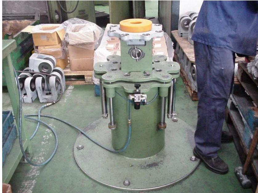
5- A continuación, se colocará otro Urelast. Se hará que el lado roscado del émbolo atraviese el Urelast.
