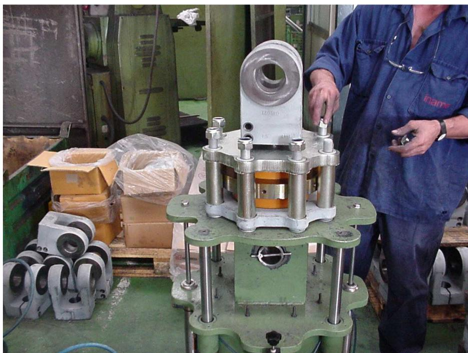
15- Una vez concluido lo que es propiamente el montaje, se pulsará el mando de accionamiento de los cilindros. Así, la placa móvil descenderá y el acceso a los centros de la placa inferior mecanizada y de la horquilla superior, quedará libre. Se medirá la distancia existente entre
