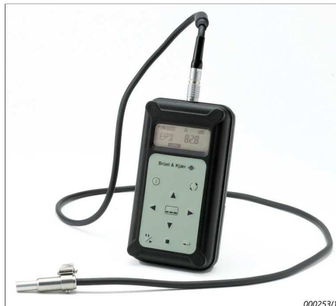
Para la medición del ruido se pueden utilizar sonómetros, sonómetros integradores promediadores y dosímetros personales (medidores personales de exposición sonora), como mínimo de clase 2 en las condiciones que se establecen en el Anexo III del Real Decreto 286/2006.
