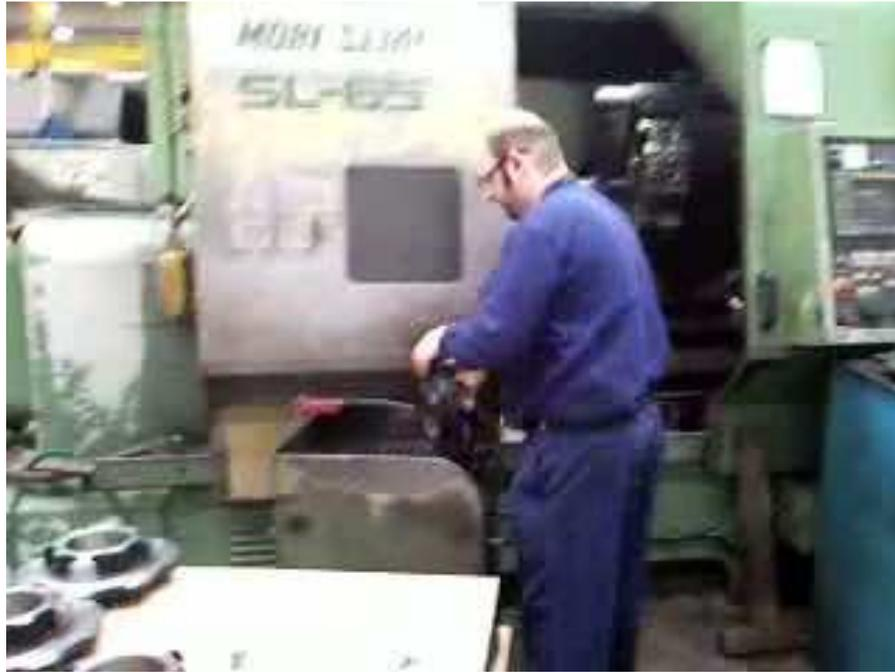
3- Tras haber limpiado la pieza y haber verificado las dimensiones tras el mecanizado, el trabajador retira la pieza del mueble y la coloca sobre otro pallet en el que están las piezas ya terminadas en esta fase.
