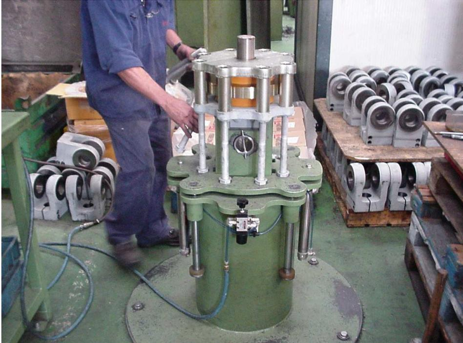
7- Después, se colocará la tapa superior del amortiguador, de manera que los rebajes de alojamiento que esta posee coincidan con los tubos para tornillo.
