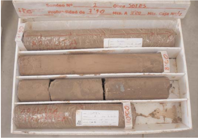
Fotografía 13.- Sondeo S-2, caja C-4, de -7.90 a -10.00 metros.
