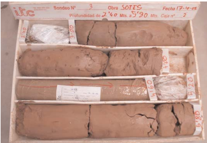
Fotografía 15.- Sondeo S-3, caja C-2, de -2.40 a -5.80 metros.
