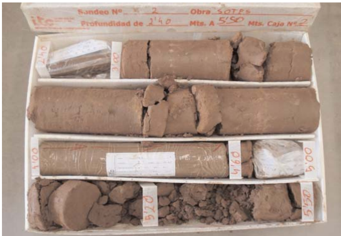
Fotografía 11.- Sondeo S-2, caja C-2, de -2.40 a -5.50 metros.
