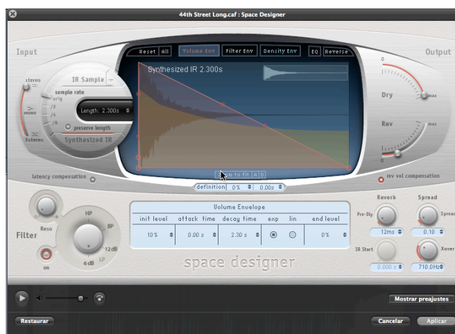
FIG 35: El Space Designer del Soundtrack Pro permite simular la reverberación de diferentes recintos.
