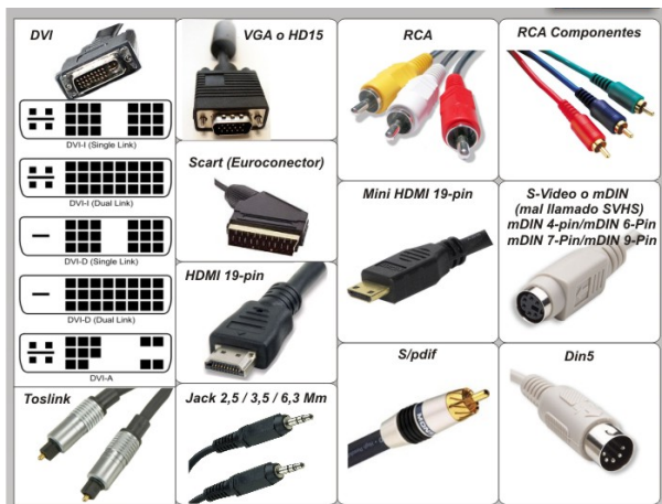
FIG 21: tipos de cables para interconecta equipos de audio.
