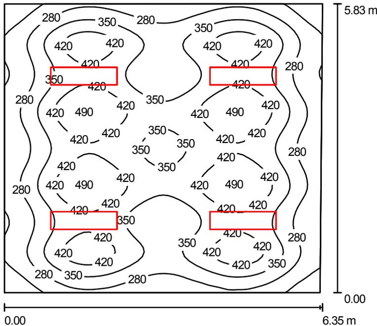
Altura del local: 2.800 m, Altura de montaje: 2.910 m, Factor mantenimiento: 0.80
