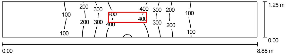
Altura del local: 2.800 m, Altura de montaje: 2.910 m, Factor mantenimiento: 0.80
