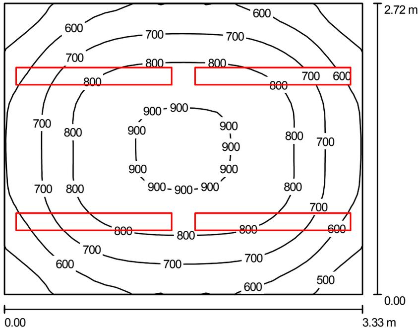
Altura del local: 2.800 m, Altura de montaje: 2.200 m, Factor mantenimiento: 0.80
