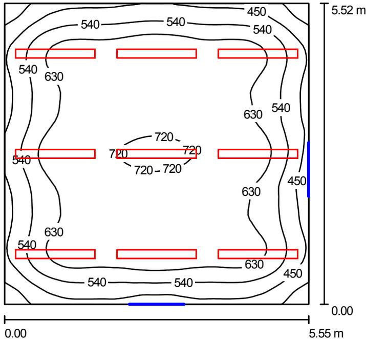
Altura del local: 2.800 m, Altura de montaje: 2.200 m, Factor mantenimiento: 0.80
