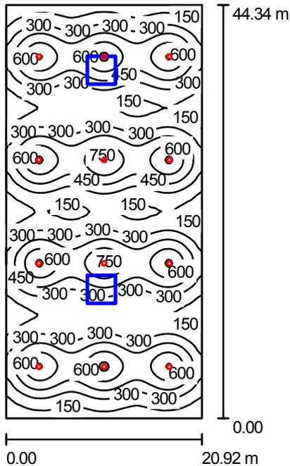
Altura del local: 5.800 m, Altura de montaje: 5.200 m, Factor mantenimiento: 0.80
