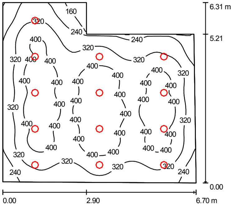
Altura del local: 2.800 m, Altura de montaje: 2.922 m, Factor mantenimiento: 0.80
