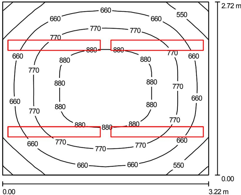
Altura del local: 2.800 m, Altura de montaje: 2.200 m, Factor mantenimiento: 0.80
