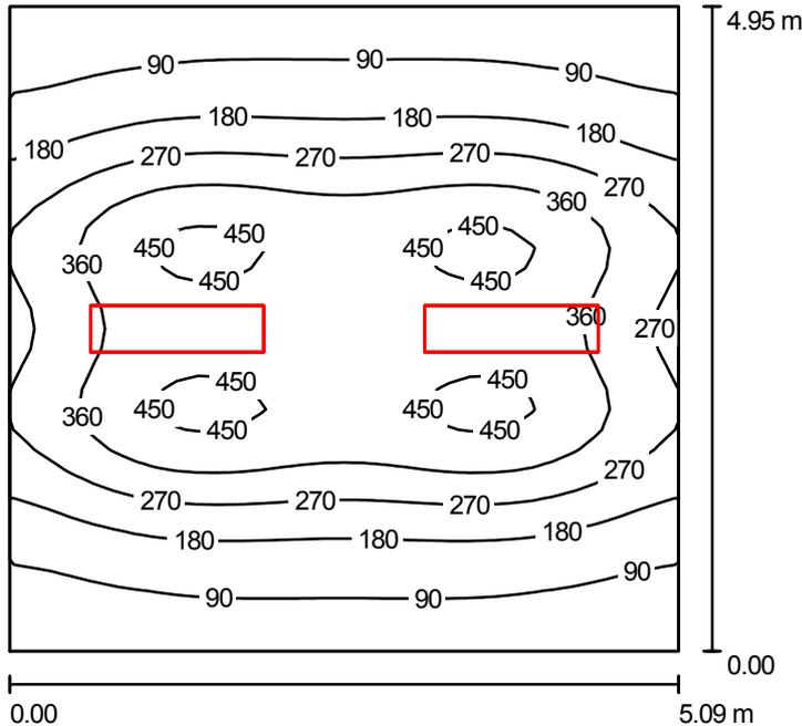
Altura del local: 2.800 m, Altura de montaje: 2.910 m, Factor mantenimiento: 0.80
