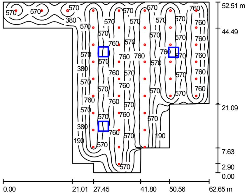
Altura del local: 5.800 m, Altura de montaje: 5.200 m, Factor mantenimiento: 0.80
