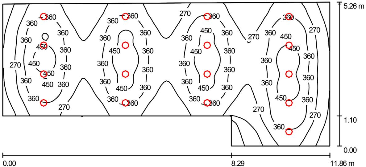
Altura del local: 2.800 m, Altura de montaje: 2.922 m, Factor mantenimiento: 0.80
