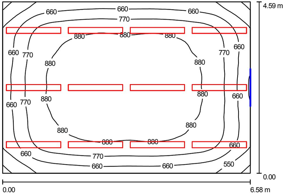
Altura del local: 2.800 m, Altura de montaje: 2.200 m, Factor mantenimiento: 0.80
