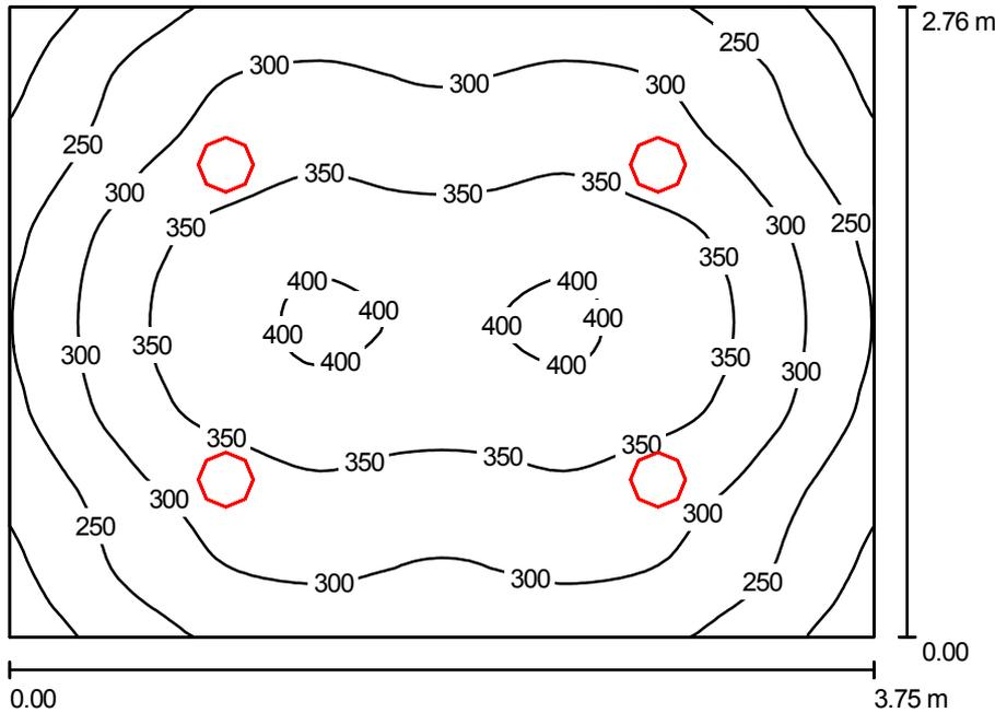
Altura del local: 2.800 m, Altura de montaje: 2.922 m, Factor mantenimiento: 0.80
