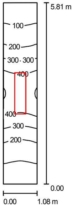
Altura del local: 2.800 m, Altura de montaje: 2.910 m, Factor mantenimiento: 0.80
