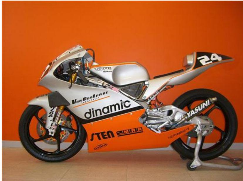
Para analizar el comportamiento estático de la suspensión de dicha moto, nos ayudamos de dos básculas y en cada una apoyamos una rueda de la moto, con lo que observamos la carga aplicada en cada una. Después de ver la carga aplicada, medimos el hundimiento de la moto, y con esto sacamos el valor de la constante de la rueda:
