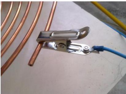
Punto de conexión móvil de la bobina primaria
