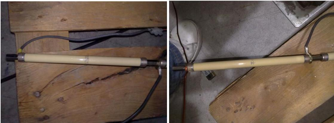
**Fig.2. 5 Diodo Semikron 17000 V**
