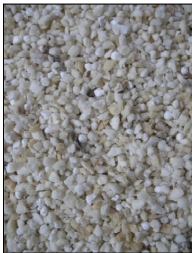
Obr. 2: Vzorek PUR pěny, zrnitost 4/8 mm
