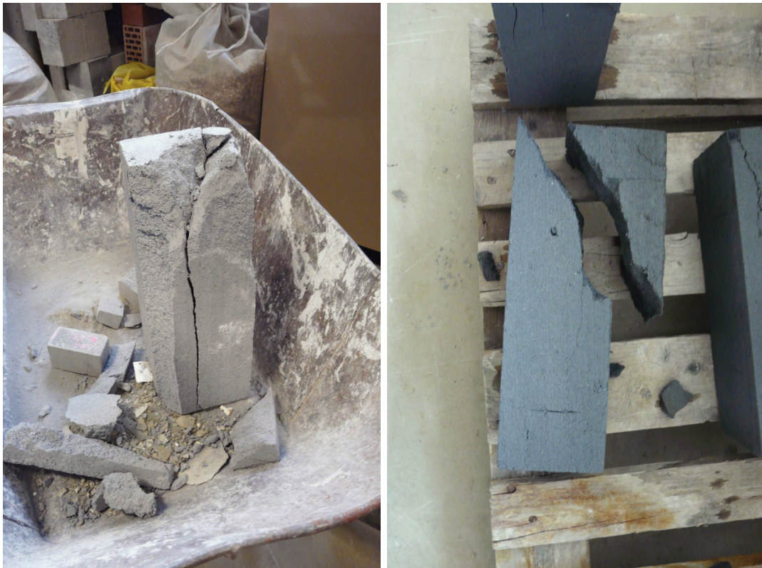
Obr. 20: Rozštípnutí vlivem špatné rovinnosti tlačné plochy a vznik smykové plochy
