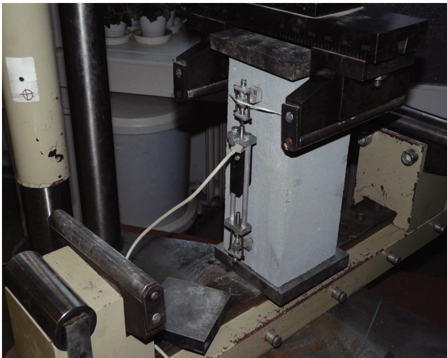
Obr. 18: Uchycení hranolu v lisu se snímačem na jedné stěně
