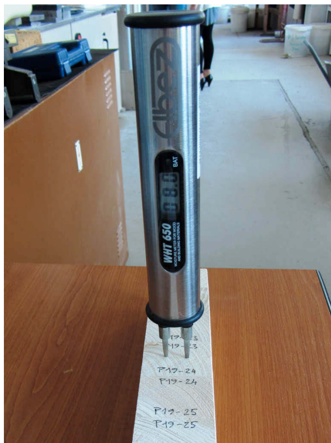
Obr. 3.2.1-2 – měření vlhkosti zkušebních hranolů přístrojem Elbez WHT-650
