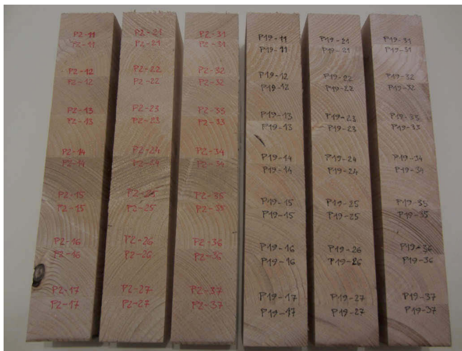
Obr. 3.2-4 – zkušební hranoly – označení lepených spojů
