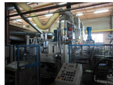
čepovací frézka s nanášedkou lepidla a průběžným podélným lisem zubovitého spoje
