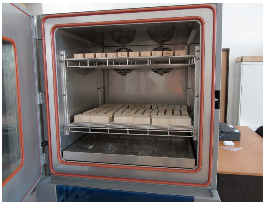
Obr. 3.2.1-1 – před vytažením zkušebních hranolů z klimatické komory CTS C-40/1000/S
