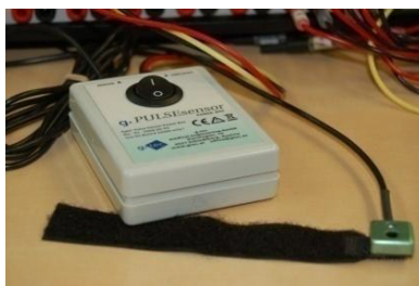
Obr.22 g.Pulse senzor pro měření pletysmografické křivky
