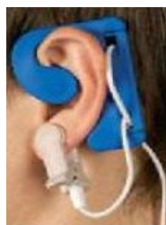
Obr.23 Optická sonda pro měření pletysmografické křivky na ušním lalůčku
