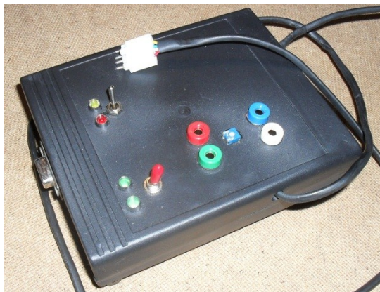
Obr.30 Měřicí přípravek pro měření pletysmografické křivky a krevního tlaku
