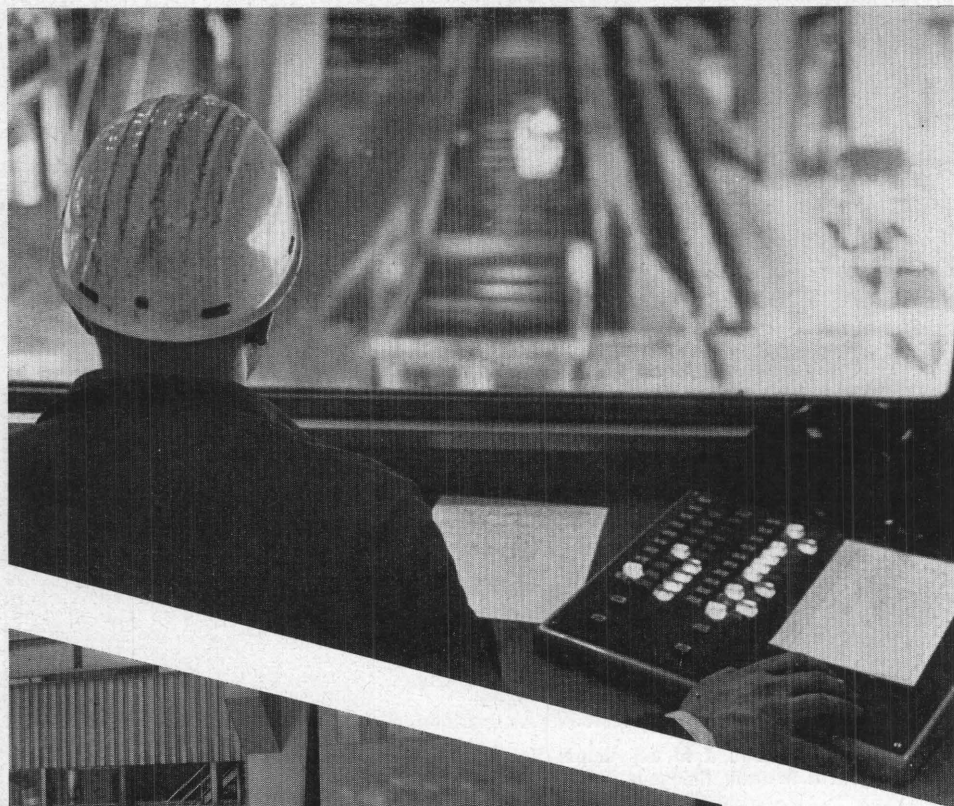
Vue du poste de commande de l'installation des fours pits sur le train de rouleaux du slabbing universel de l'usine Beeckerwerth. (August-Thyssen-Hütte AG)
