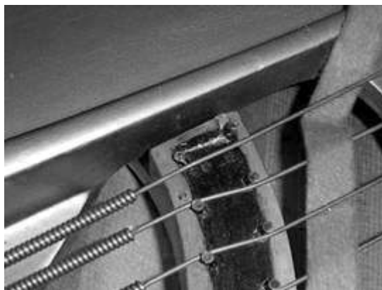
図 9-24 ヒッチピン部における弦の解放
