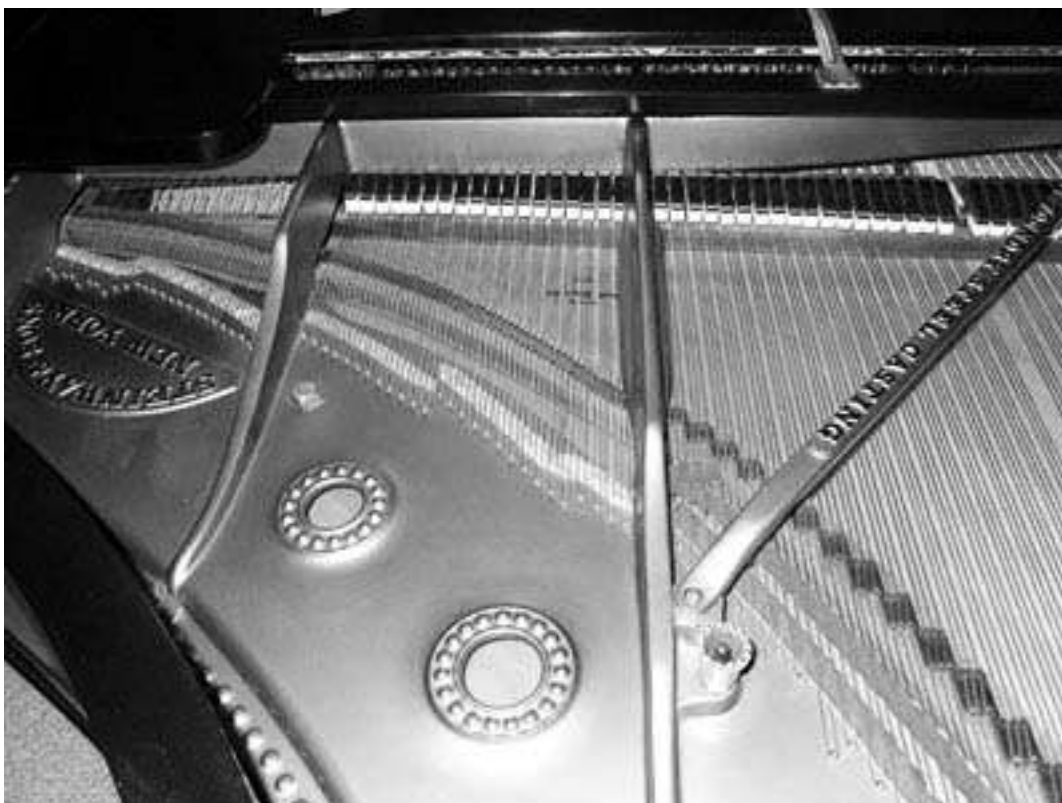
図 9-12 ヴィンテージ張弦法における“リヤ・デュプレックス・スケール”の例(その2)
