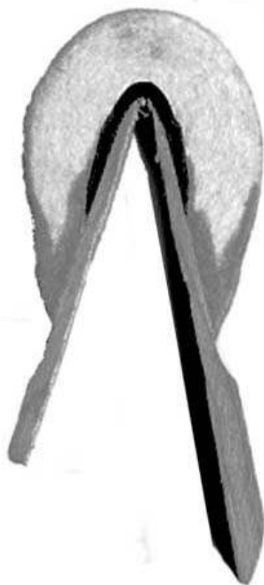
図 2-3 現在のハンマー：ハンマーウッドにウェッジエンドまで鋸目を入れた状態
