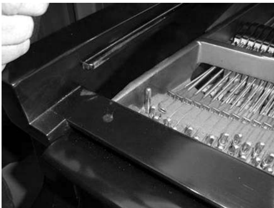
図 9-40 チューニングピンによるチップの1次打込み、硬化待ち
