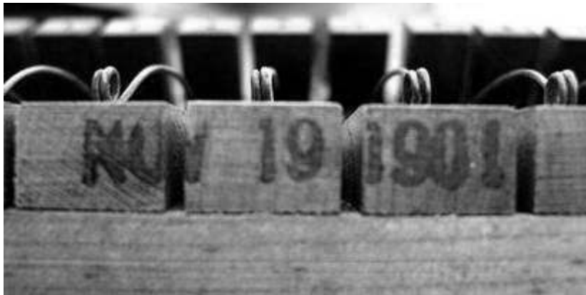
図 9-3 ダンパー、アンダーレバー・フランジに押されていたスタンプ
