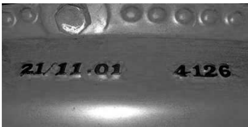
図 9-2 No.104611 の鉄骨後部に浮き出された数字と記号
