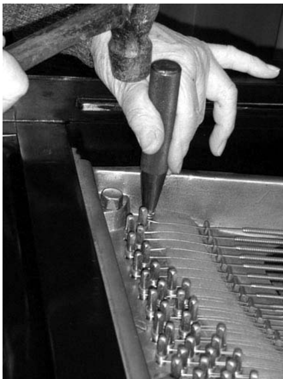
図 9-44 高さ合せのための最終打込み
