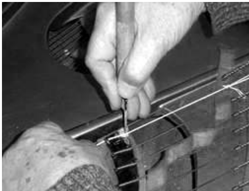
図 9-34 風糸を張って新たなピン孔の位置を決定し、ドリリング
