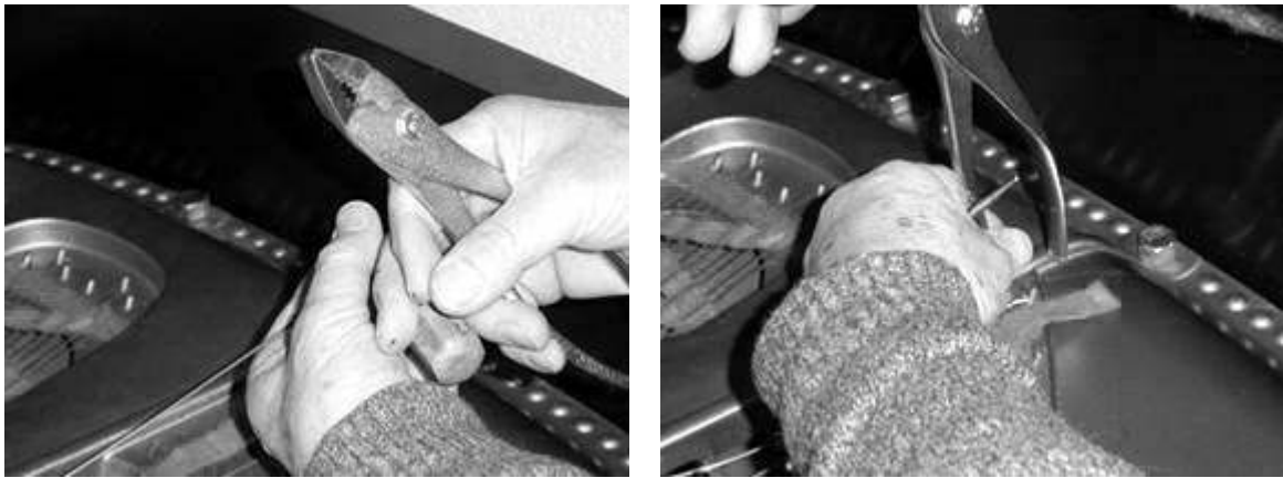
図 9-43 ヒッチピン側の取付……ツイストしながら
