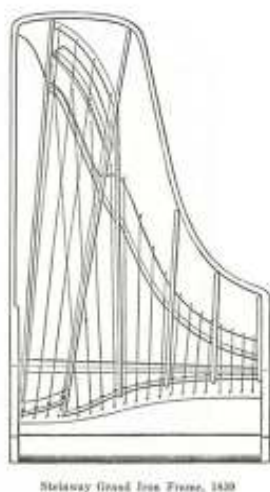
図 8-5 H. スタインウェイ Jr.が特許を取得したグランドピアノ用交差・扇形配方式
