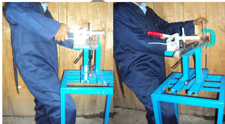
Gambar 4.30 Pemasangan benda kerja
