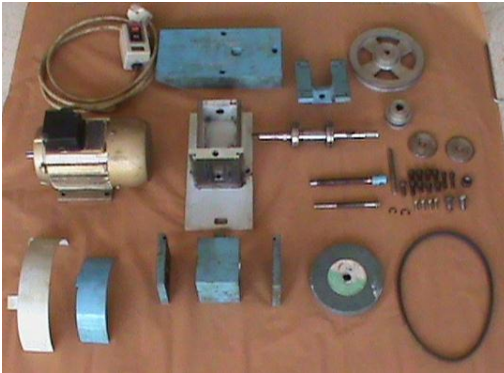
Gambar 3.21. Komponen alat gerinda silindris.
