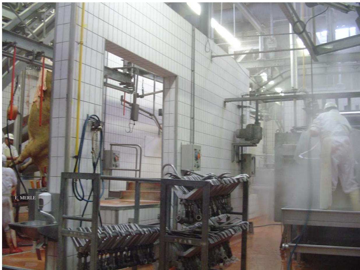
Photo 1 : Nettoyage de la chaîne d'abattage des porcins. Le nettoyage entraîne des projections d'eau, alors que l'abattage des bovins est en cours à proximité.
