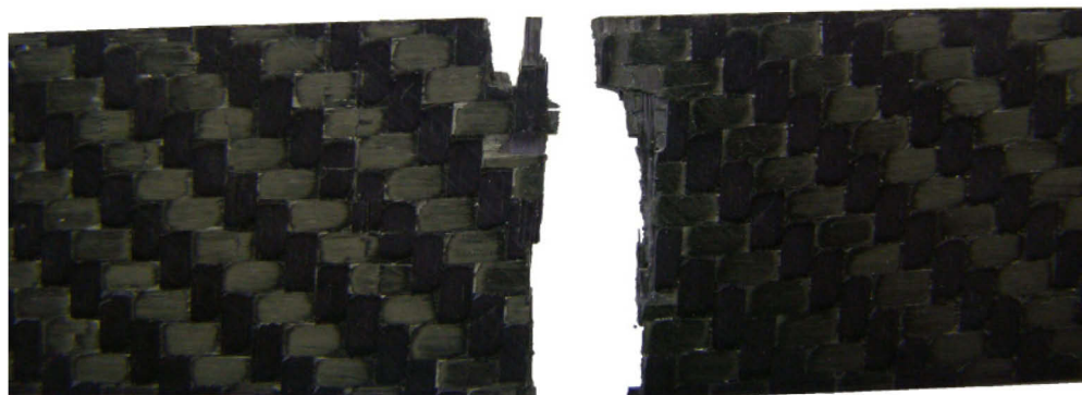
Obrázek 26. Detail porušení zkušebního pásku
