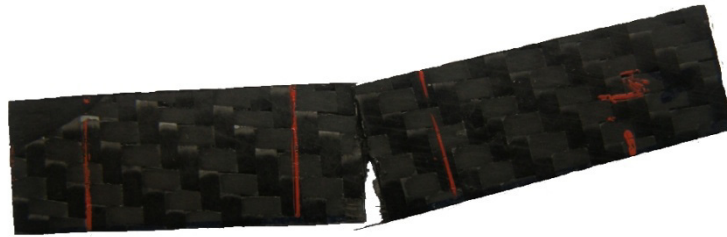
Obrázek 29. Lom zkušební tyčinky v tříbodovém ohybu
